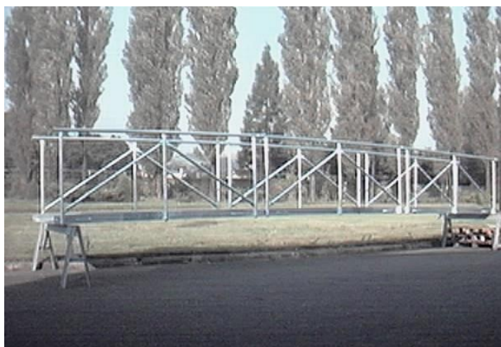
obr. 1 prototyp Havarijní lávky typ "HL3", zatěžovací zkoušky
